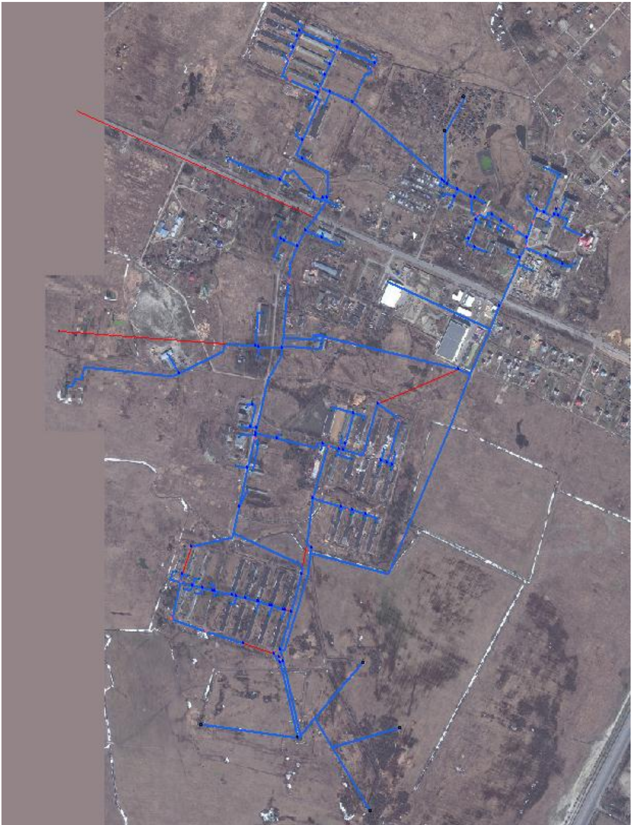
Рисунок 30 - Схема прокладки существующего и перспективного водовода в дер Малое Карлино (красным цветом обозначены заглушенные участки)
