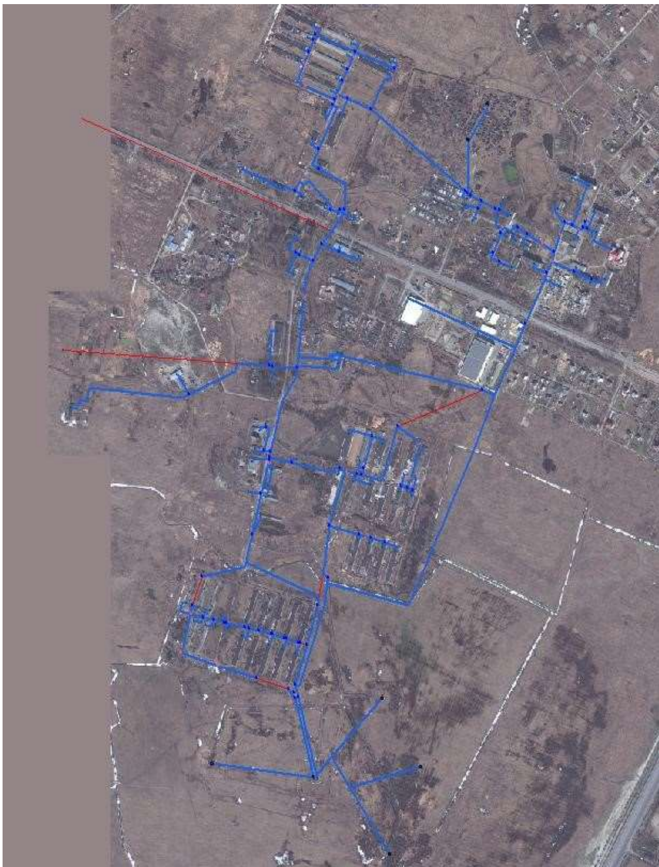
Рисунок 29 – Схема прокладки существующего и перспективного водовода в дер. Малое Карлино (красным цветом обозначены заглушенные участки)
